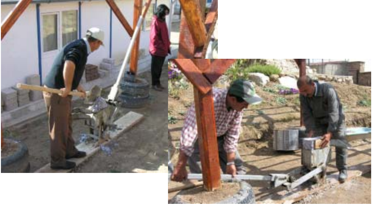
Şekil 19. Parry kerpiç tuğla presi aynı zamanda geri dönüştürülmüş kağıt hamurunun geleneksel sobalarda yakıt olarak kullanılmasını sağlamak için sıkıştırılmasında kullanılmaktadır.
