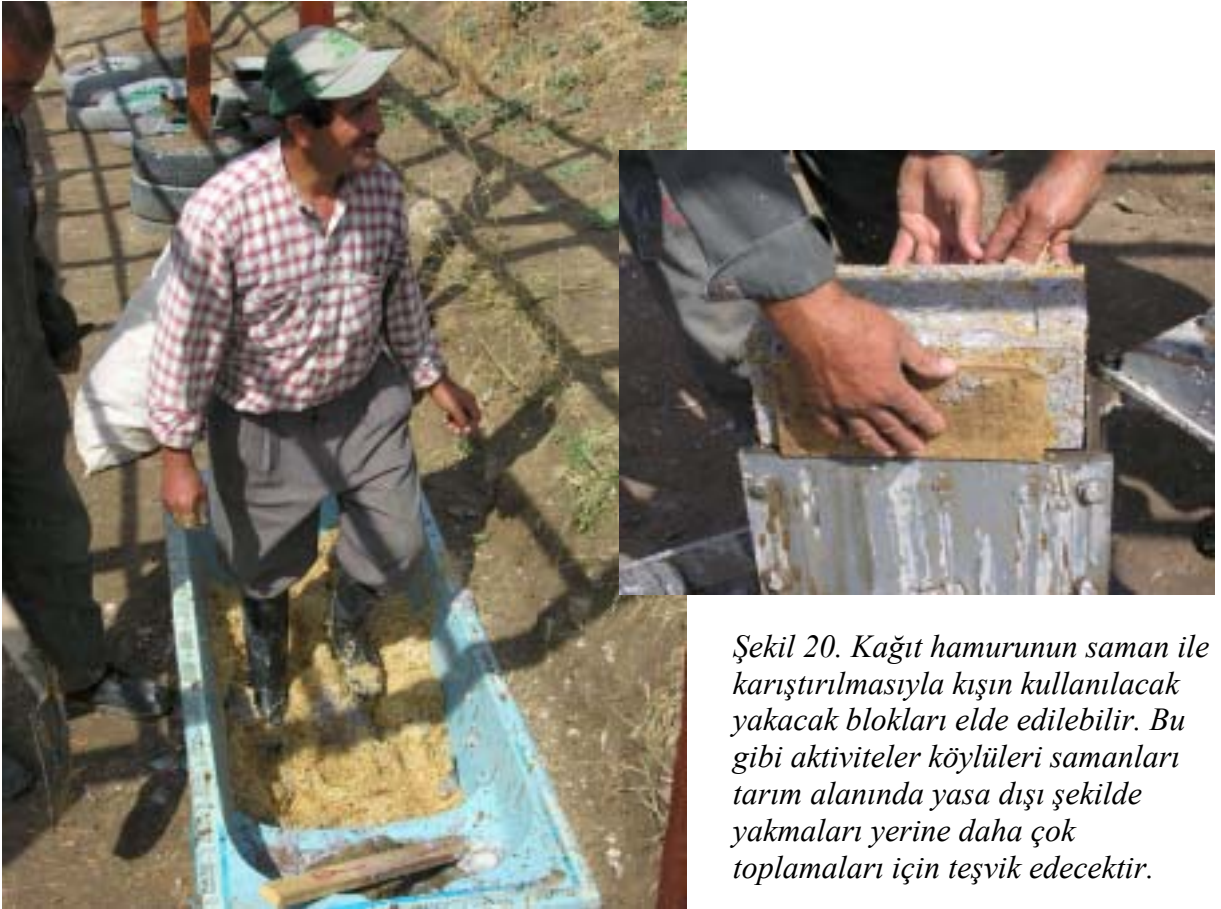
Şekil 19. Parry kerpiç tuğla presi aynı zamanda geri dönüştürülmüş kağıt hamurunun geleneksel sobalarda yakıt olarak kullanılmasını sağlamak için sıkıştırılmasında kullanılmaktadır.
